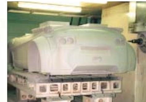
Das Positiv für die Karosserieform wird aus einem vollen Hartschaumblock gefräst.
