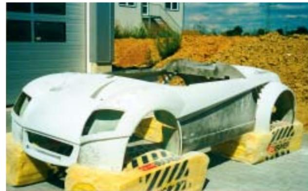
Die Außenhaut des 3,55 m kurzen Zweisitzers besteht aus Kohlefaserverbundwerkstoff. Türen fehlen beim Prototypen.
