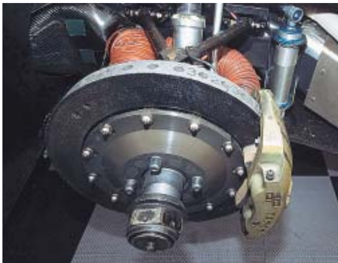
Über Schläuche werden die Bremsen mit Kühlluft versorgt
