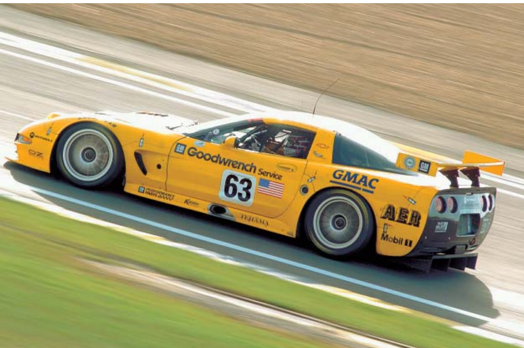
Der Sieben-Liter-V8 Motor erzeugt ein Drehmoment von satten 773 Newtonmeter. Die winzigen Restriktoren lassen der Renncorvette nur wenig Luft zum Atmen
