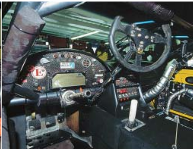
Geschaltet wird wie beim Serienauto: Das Sechsganggetriebe liegt wegen der Gewichtsverteilung vor der Hinterachse
