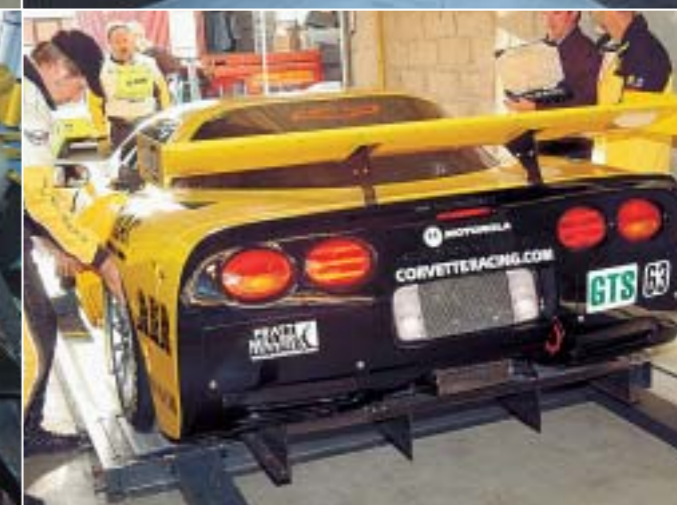
Der mächtige Diffusor beschleunigt die Luft am Unterboden. Zusammen mit dem Heckflügel erzeugt der Diffusor bei Topspeed bis 800 kg Abtrieb allein an der Hinterachse
