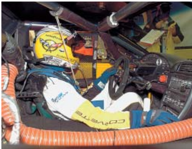
Eng geht es im Corvettescockpit zu. Die Servolenkung entspricht in den Grundbauteilen der des Serienautos
