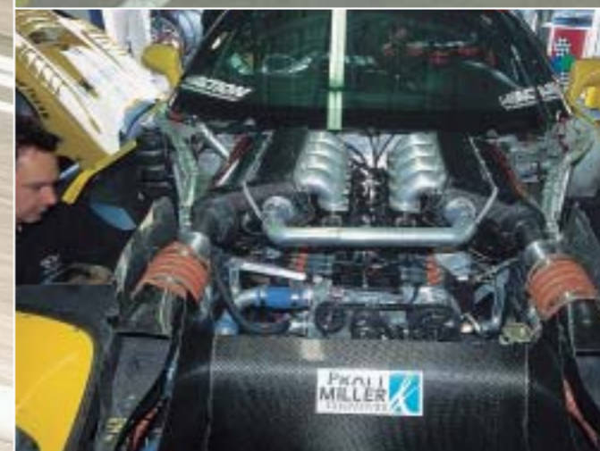
Der Sieben-Liter-V8 Motor erzeugt ein Drehmoment von satten 773 Newtonmeter. Die winzigen Restriktoren lassen der Renncorvette nur wenig Luft zum Atmen
